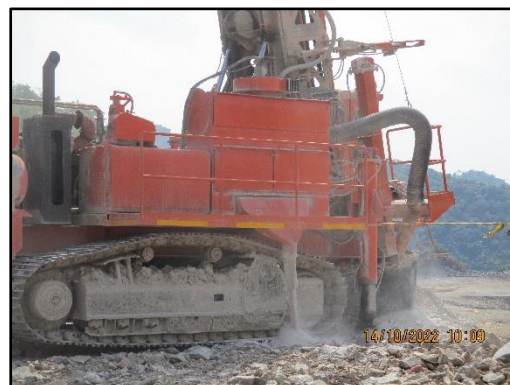
ภาพที่ 2.10 ตัวอย่างอุปกรณ์ฝุ่นประจำรถเจาะระเบิด
