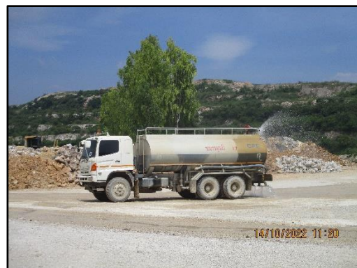
ภาพที่ 2.13 รถบรรทุกฉีดพรมน้ำบนเส้นทางลำเลียง
