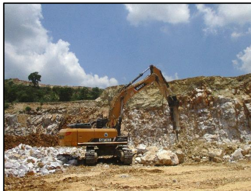
ภาพที่ 2.28 Hydraulic Breaker สำหรับทุบหิน
