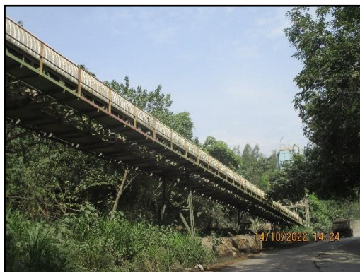
ภาพที่ 2.18 สายพานลำเลียงหินเป็นแบบปิด
