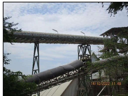
ภาพที่ 2.18 สายพานลำเลียงหินเป็นแบบปิด
