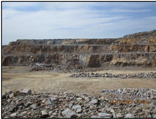
ภาพที่ 2.6 การเปิดหน้าเหมืองแบบขั้นบันได
