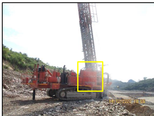
ภาพที่ 2.10 ตัวอย่างอุปกรณ์ฝุ่นประจำรถเจาะระเบิด
